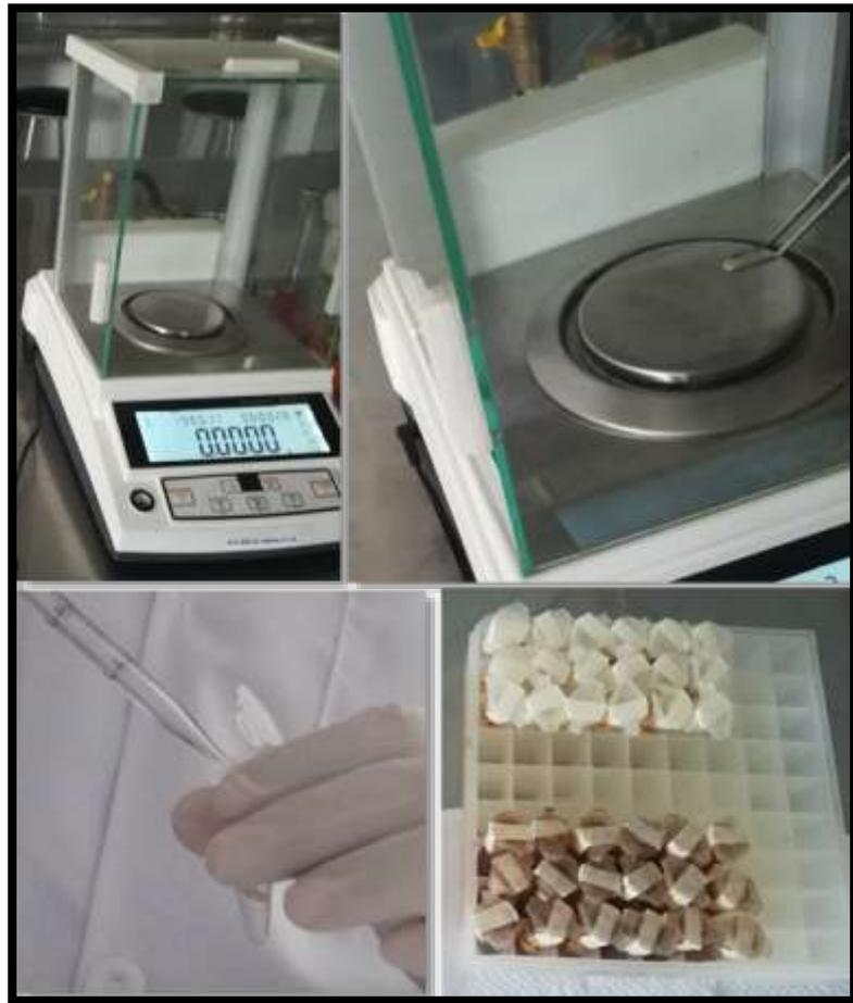
Figura 6. Peso de cada disco en la balanza analítica y colocación de las soluciones con una pipeta
